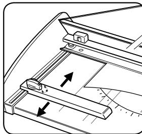
Чтобы выполнить необходимую регулировку, переведите стопорный рычаг в положение (↑). Чтобы заблокировать аппарат, переведите стопорный рычаг в положение (🔒).
