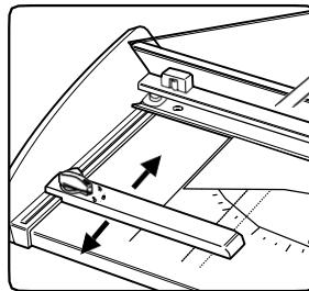
Lai pārvietotu ierobežotāju, pagrieziet bloķēšanas sviru uz ( ). Lai bloķētu, pagrieziet bloķēšanas sviru uz ( ).
