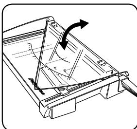
В целях транспортировки и хранения предохранительное устройство SafeCut™ опускают вниз, тем самым прижимая рукоять, чтобы предотвратить возможность получения травмы. В поднятом положении SafeCut™ направляет режущую планку/рычаг ножа и обеспечивает безопасность пользователя во время резки ножом. *Не помещайте пальцы под режущую планку и не касайтесь ножа.*
