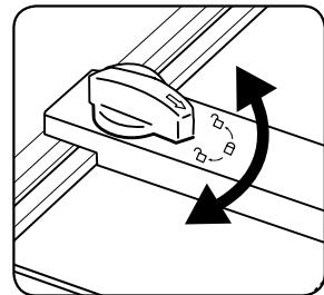
Блокировка и разблокировка направляющей кромки выполняется поворотом рукоятки.
